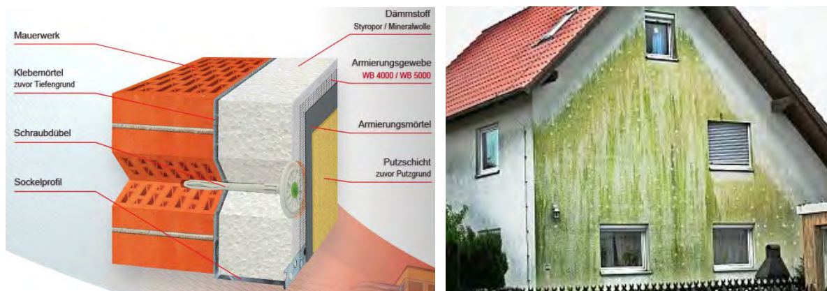
Abbildung 2 Aufbau eines Wärmedämmverbundsystemes (WDVS) einer Hauswand (links) [13] und der sichtbaren Auswirkungen der Wärmebrücken auf die Fassade (rechts) [14].
